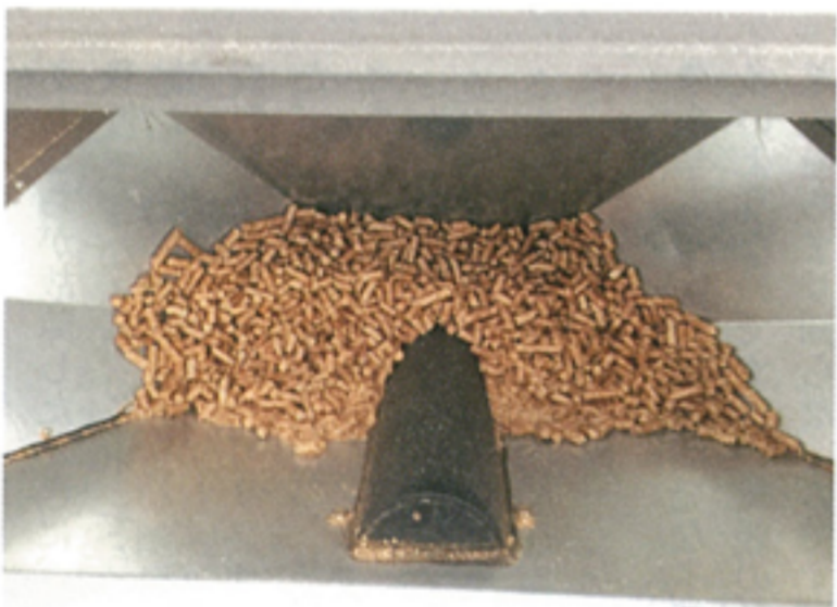
ペレットの燃料形状。燃料のサイズは \approx 6\phi\text{mm} \times 15 \sim 20\text{mm} です。これをスクリーモーターで燃料ホッパーの底部から燃焼炉に供給します。
